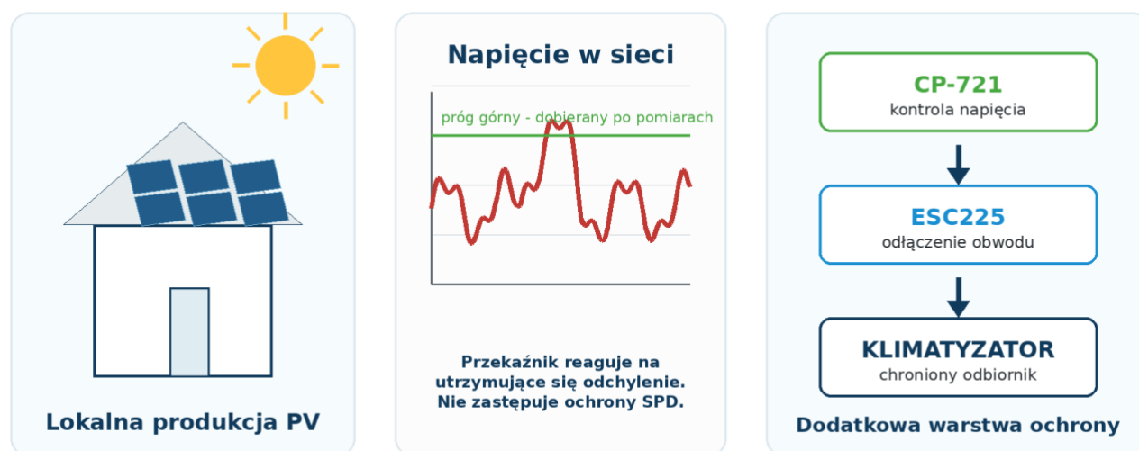
Rys. 1. Zasada działania dodatkowej kontroli napięcia. Opracowanie własne Voltklima.
